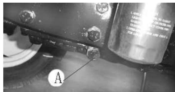
Рис.5-23 замена масла донника двигателя
